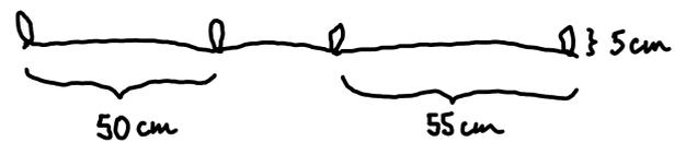
24. Wenn das Zugfahrzeug einen Gepäckträger besitzt, kann man den vergrößerten Anhänger durch die im vorigen Schritt vorbereitete Gummileine (23) gegen Umkippen bei zügiger Fahrt auf kurvigen oder unebenen Wegen sichern. Dazu befestige man die Leine mit den mittleren Schleifen an den vorderen Klampen des Aufsatzrahmens (16). Die Schlaufe mit dem kürzeren Seilende kommt dabei auf die Deichselseite des Anhängers, also in Fahrtrichtung links.
